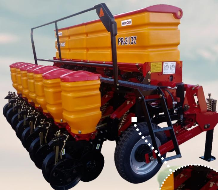
Linha Pantográfica com mola central de fácil acesso para aperto, sem graxerias e montado com material auto lubrificantes.
