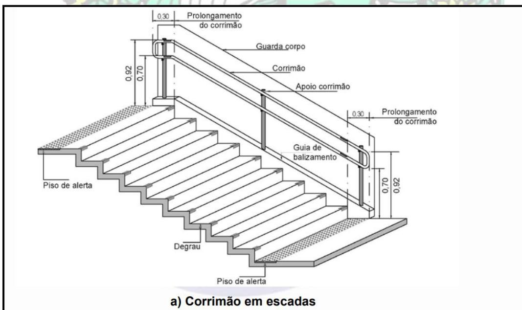
**Figura 21 - DETALHE CORRIMÃO EM PAREDE – NBR 9050**
