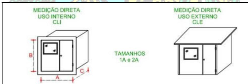
**Figura: Modelo de caixa de medição**
