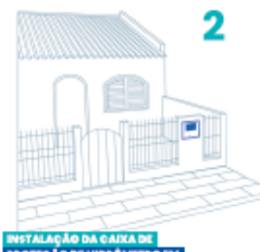
2 INSTALAÇÃO DA CAIXA DE PROTEÇÃO DE HIDRÔMETRO EM MURETA FRONTAL COM GRADE
