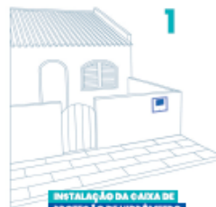
1 INSTALAÇÃO DA CAIXA DE PROTEÇÃO DE HIDRÔMETRO NO MURO FRONTAL
