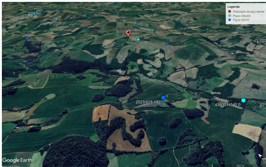
Figura 1. Modelo digital de elevação disponibilizado pelo software Google Earth Pro apresentando a configuração geomorfológica com indicação dos poços próximos cadastrado no SIOUT e SIAGAS, bem como do local do poço tubular a ser perfurado. Exagero vertical de 3x com aproximadamente 25° em relação à superfície.
