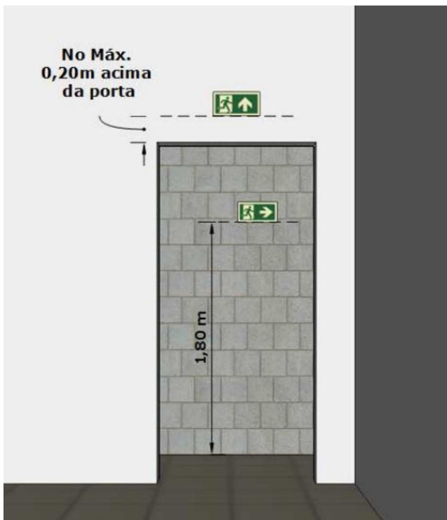
SINALIZAÇÃO DO SENTIDO DA ROTA DE FUGA
