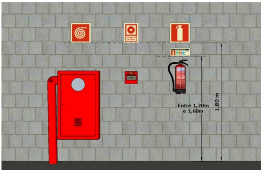
SINALIZAÇÃO BÁSICA DE EQUIPAMENTOS
