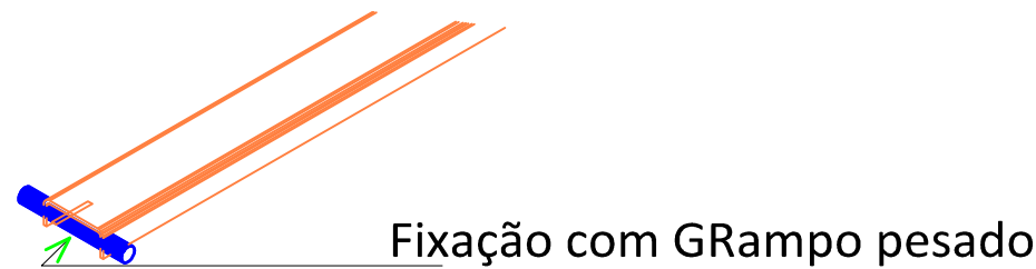
Detalhe da Fixação dos Tirantes nos cabos de sustentação da ponte Esc.: 1:20
