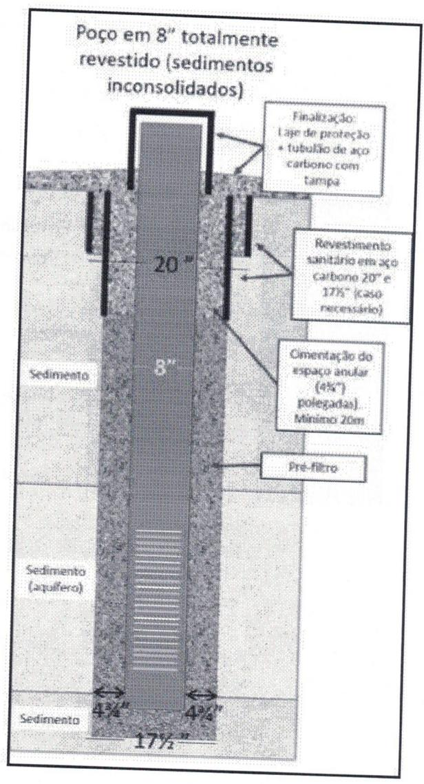
Para se adequar as condições geológicas e hidrogeológicas locais, foi elaborado o projeto construtivo esquemático abaixo, que deverá ser utilizado como referência para a perfuração do poço localizado na Linha Teodoro, localizada no interior do Município de Campos Borges – RS.
