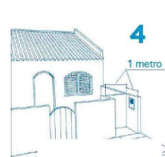
Instalação da caixa de proteção de hidrômetro no recuo do muro (nicho)
