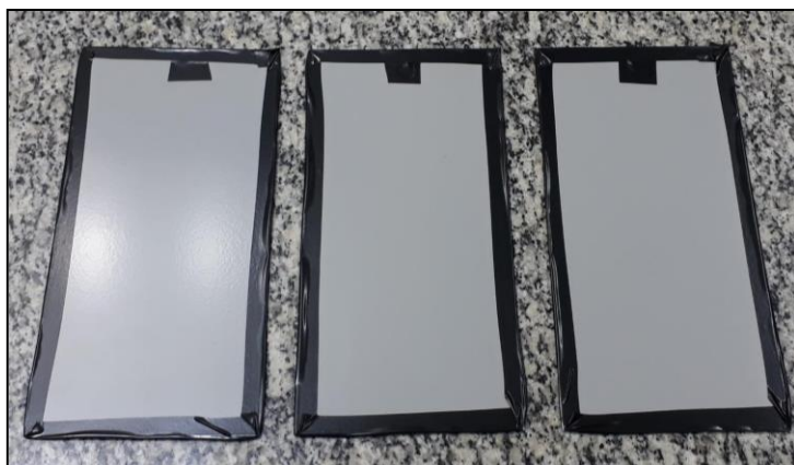
Foto 3 – Chapas após 360 horas em exposição
