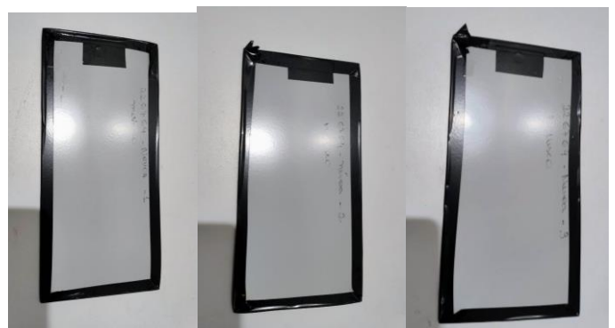
Foto 3 – Amostra sem regiões de solda após 1176 horas em exposição
