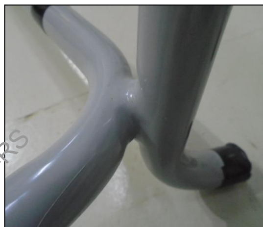
Foto 12 – Amostra da cadeira com região de solda após 300 horas em exposição
