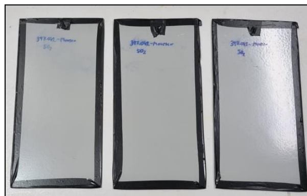
Foto 3 – Amostra sem regiões de solda após 10 ciclos em exposição
