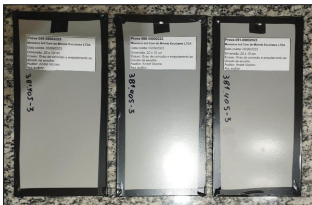
Foto 2 – Chapas antes do ensaio
