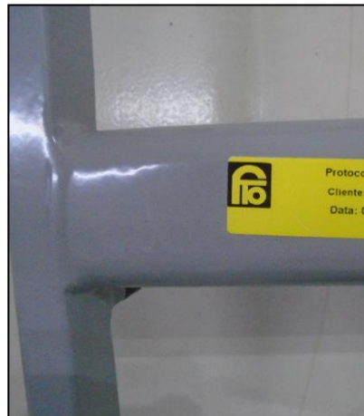
Foto 6 – Amostra da mesa com região de solda antes do ensaio
