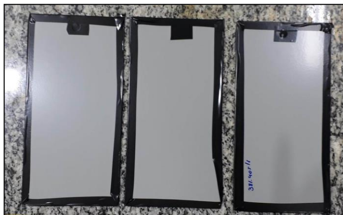
Foto 3 – Chapas após 336 horas em exposição
