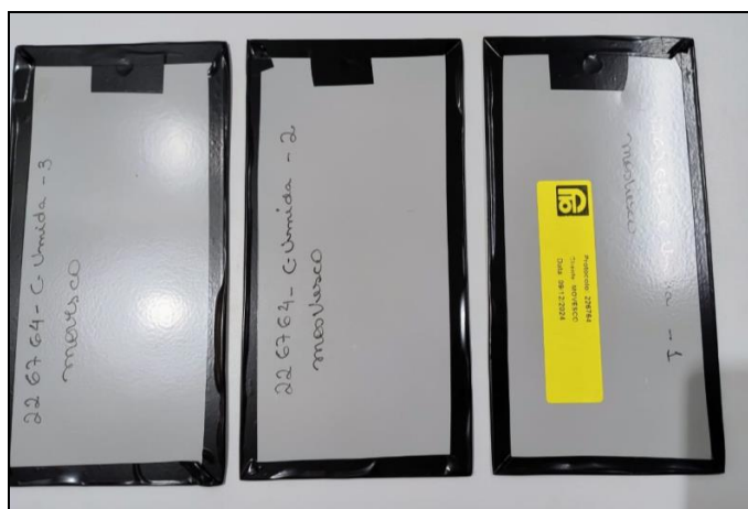
Foto 2 – Amostra sem regiões de solda antes da exposição
