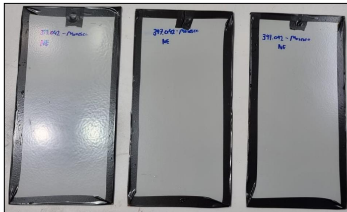
Foto 3 – Chapas após 336 horas em exposição
