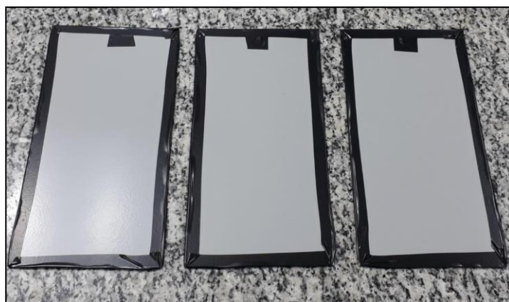
Foto 3 – Chapas após 15 ciclos em exposição
