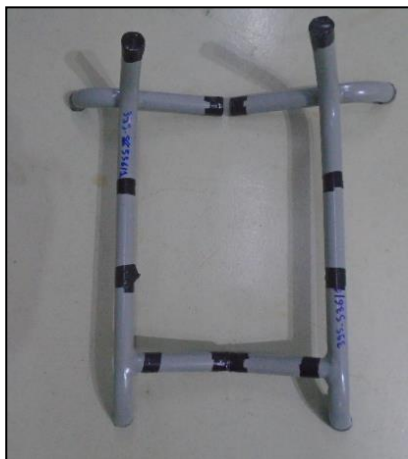
Foto 9 – Amostra da cadeira seccionada antes do ensaio
