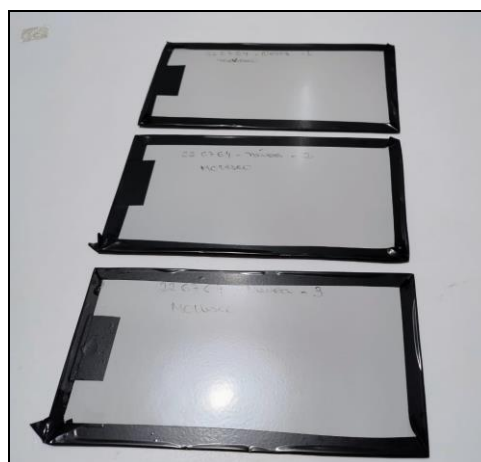
Foto 3 – Amostra sem regiões de solda após 1152 horas em exposição
