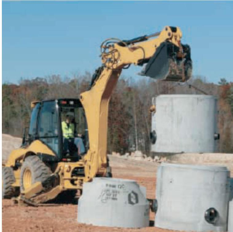
Se for especificado o uso da máquina para elevação de cargas, deverá haver ganchos ou dispositivos para esse fim na caçamba e deverá estar disponível uma tabela de capacidade de içamento na cabina e na literatura técnica, juntamente com uma advertência sobre o risco de se utilizar os dentes da caçamba para fixação de cabos de aço.
