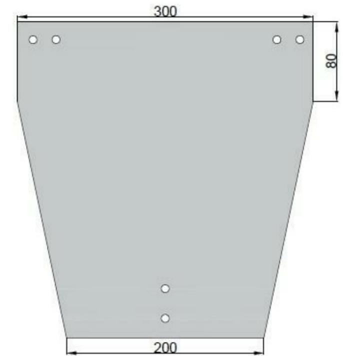
SUPORTE DE FIXAÇÃO EM AÇO GALVANIZADO
