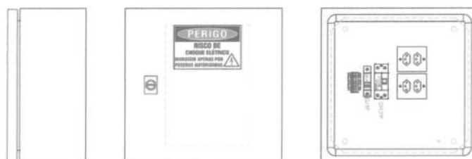
QUADRO TIPO 2 - TRAILERS A:400mm X L:400mm X P:200mm
