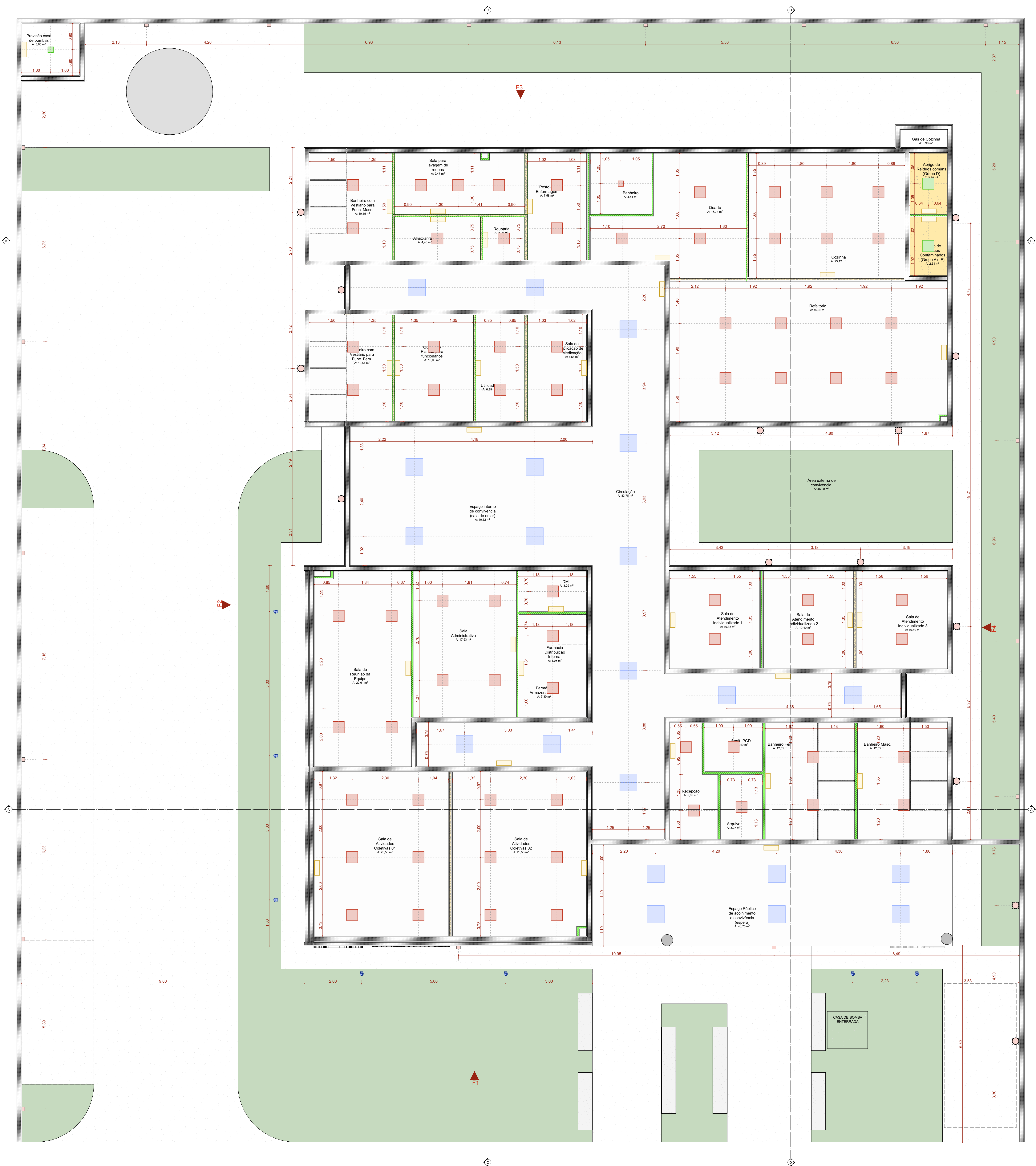
PLANTA FORRO E LUMINOTÉCNICO Escala: 1:50
