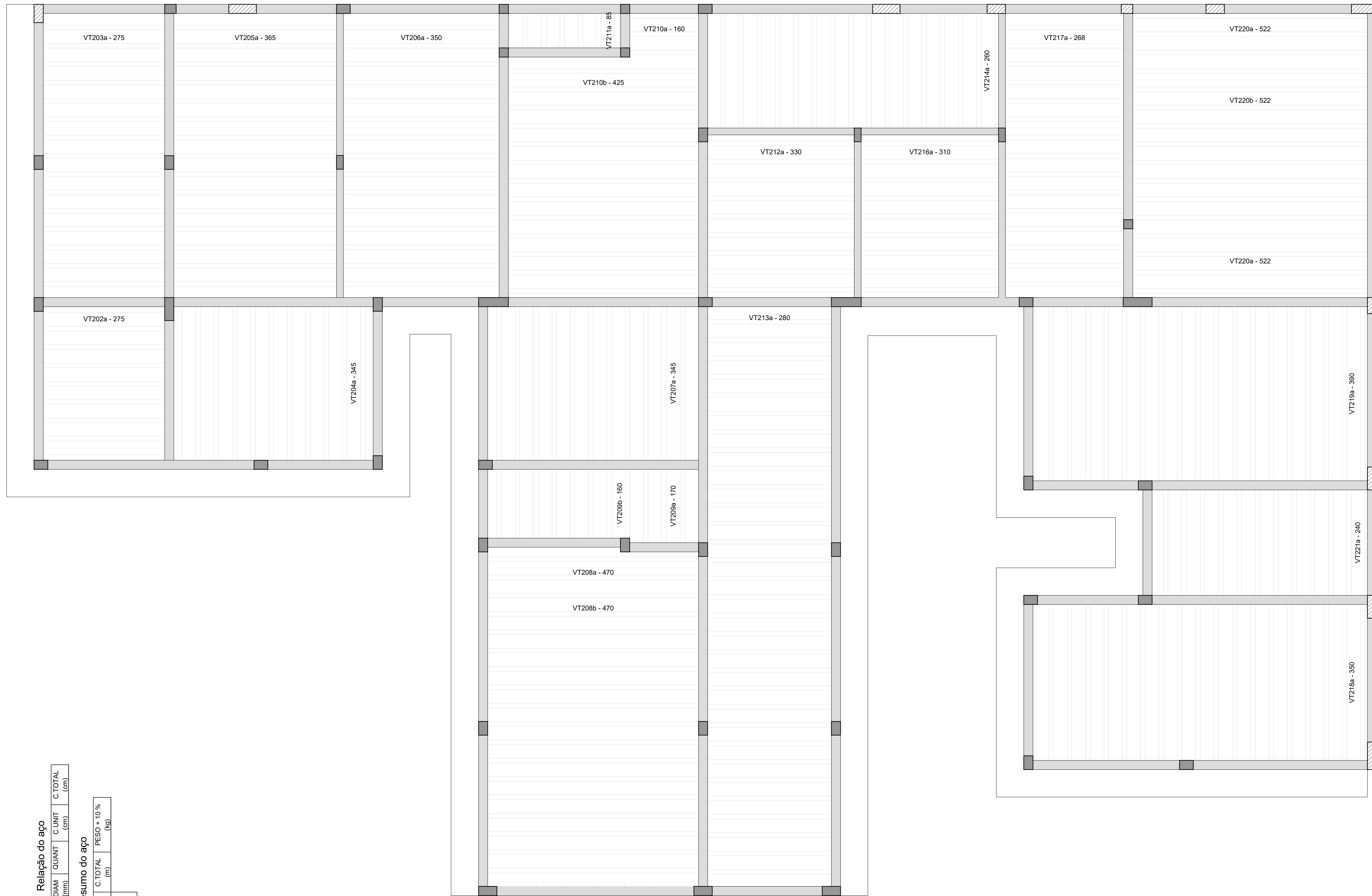
Planta de vigotas pré-moldadas escala: 1:50
