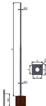
Deverá ser instalado um suporte simples de encaixe para tubo de 60,3mm para acoplamento do suporte ao poste e furação de 60,3mm para conexão da luminária.
