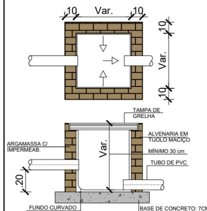
OBS: FAZER INCLINAÇÃO DO PISO NO SENTIDO DE ESCOAMENTO DAS ÁGUAS, FORMANDO UMA CALHA EM CONCRETO
