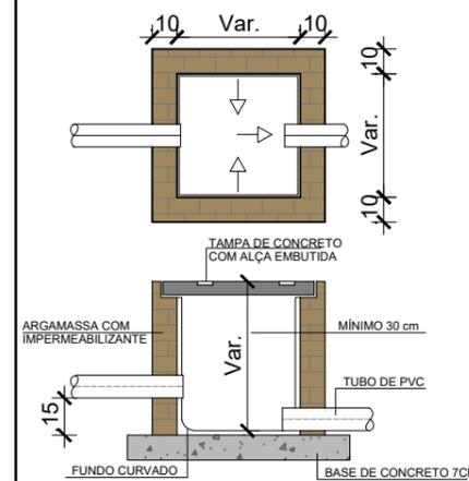
OBS: FAZER INCLINAÇÃO DO PISO NO SENTIDO DE ESCOAMENTO DAS ÁGUAS, FORMANDO UMA CALHA EM CONCRETO.
