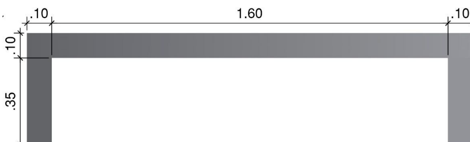
CORTE FRONTAL BANCO ESCALA 1:10
