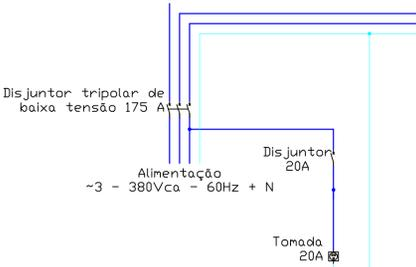
Diagrama Multifilar de Baixa Tensão
