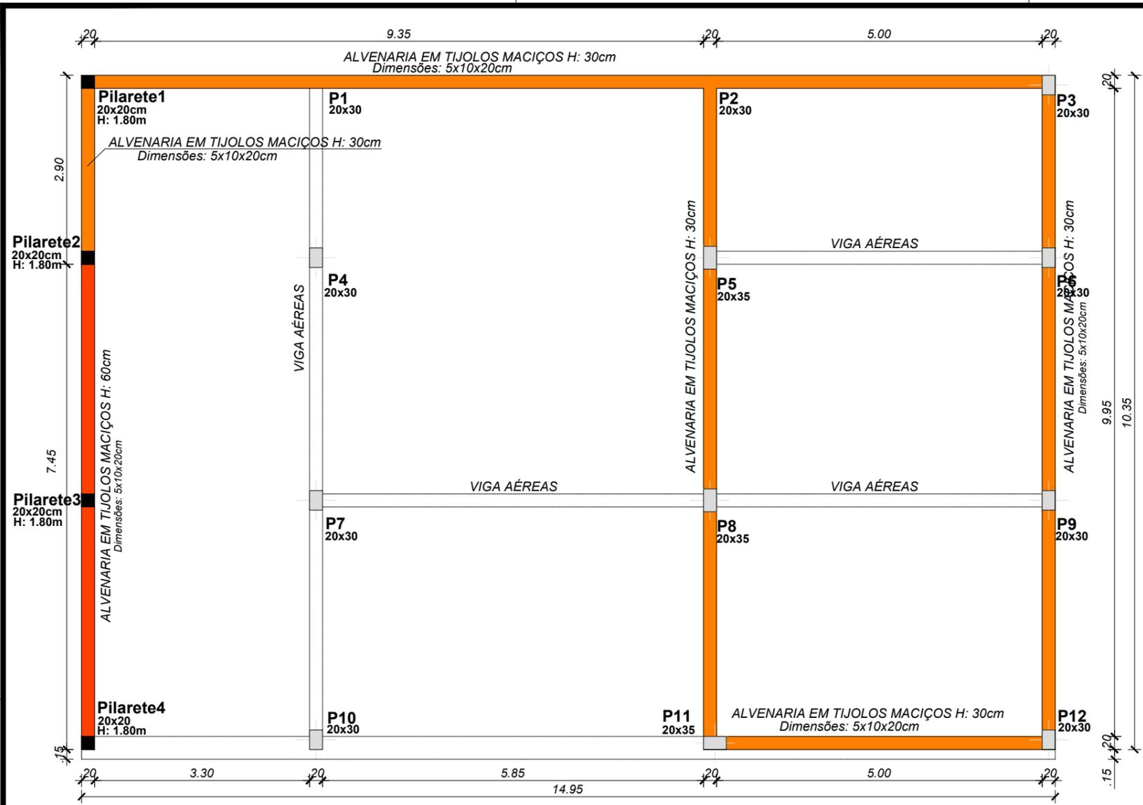
**08 PLANTA ALVENARIA DE TIJOLOS MACIÇOS**
