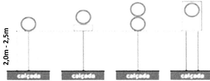
**11 - REPRESENTAÇÃO ESQUEMÁTICA PARA CONJUNTO IDENTIFICADOR DE VIAS E LOGRADOUROS PÚBLICOS**
