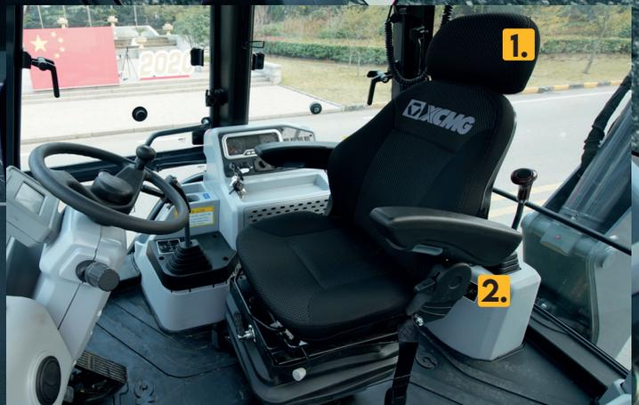
**1.** Banco do operador ergonômico com apoio de braço, suspensão regulável, com giro de 180°.
