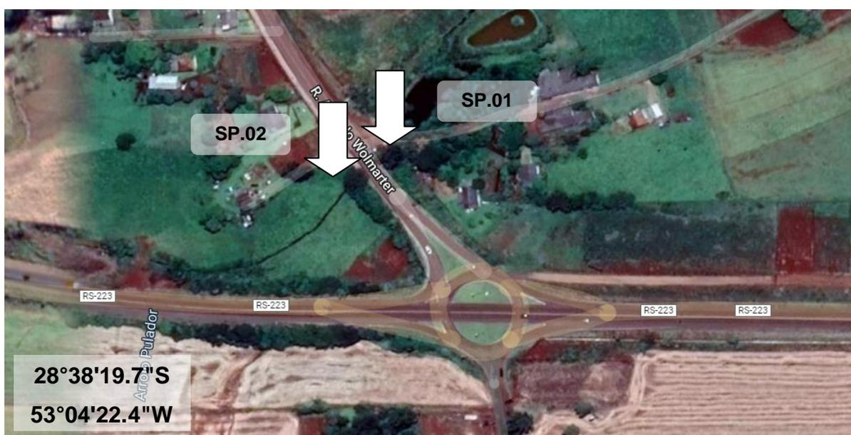
**Figura 1 – Locais dos ensaios de sondagem (28°38'19.7"S 53°04'22.4"W).**
