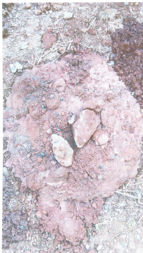
Figura 1: Imagem evidenciado a saída de fragmentos de rocha na boca do poço, os quais estavam desprendendo-se das paredes do poço.
