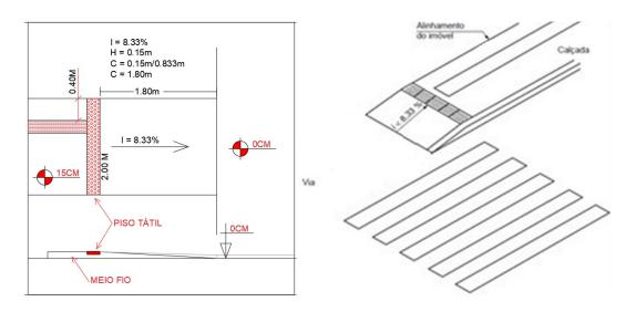
**5.3 PASSEIO PÚBLICO:** Consiste na execução de lastro de brita espalhado de forma homogênea com 5cm de espessura que é a base de regularização e drenagem da pavimentação (passeios). Sobre este lastro de brita será executado lastro de concreto, também com 5cm de espessura.
