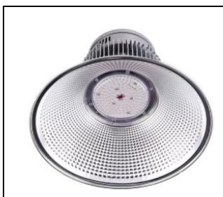
**0.9.3.5 LUMINÁRIAS:** Os pontos de luz de teto serão rigorosamente centrados e alinhados conforme projeto elétrico. A iluminação geral será com luminárias LED tipo industrial: Potência: 300W; Tensão: bivolt automático; Proteção: IP65 (à prova de poeira e protegido contra jatos de água); Cor da luz: branco frio 6500K; Fluxo luminoso: 31.000 lúmens; Ângulo de
