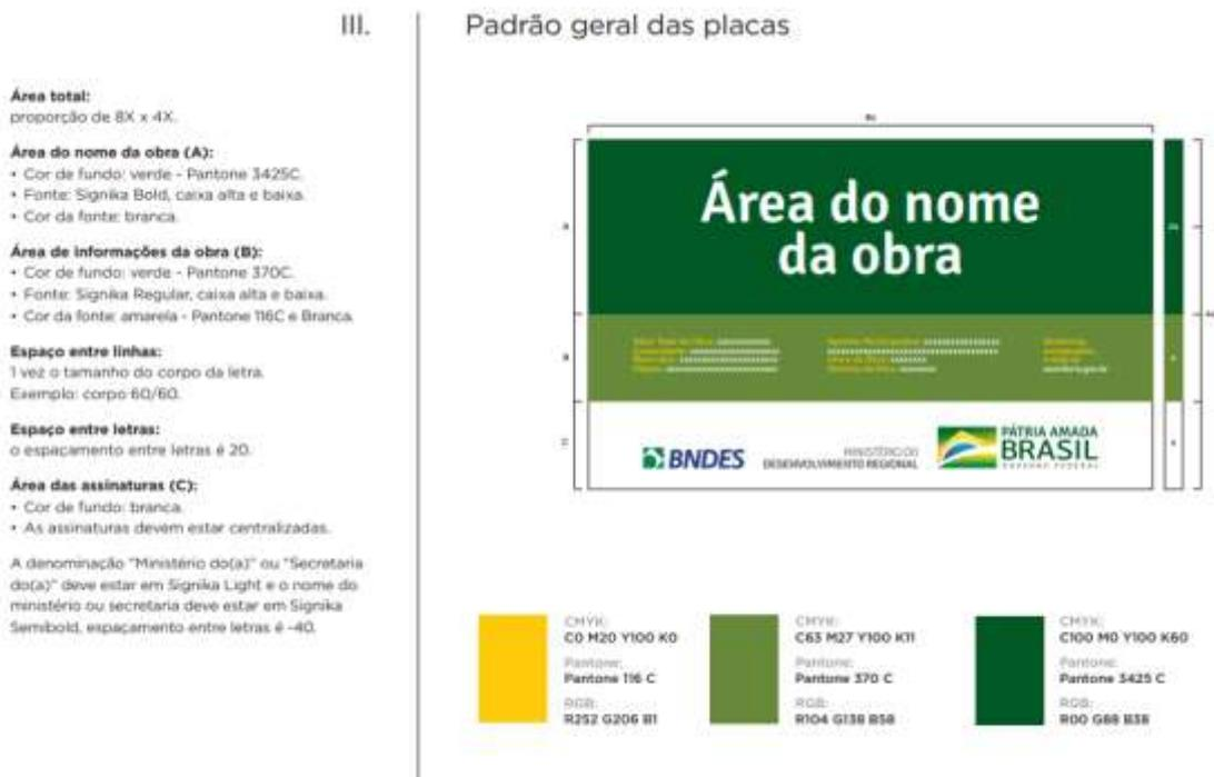
FIGURA 1 – Modelo de Placa Padrão CAIXA – Medindo 2,4x1,2m
