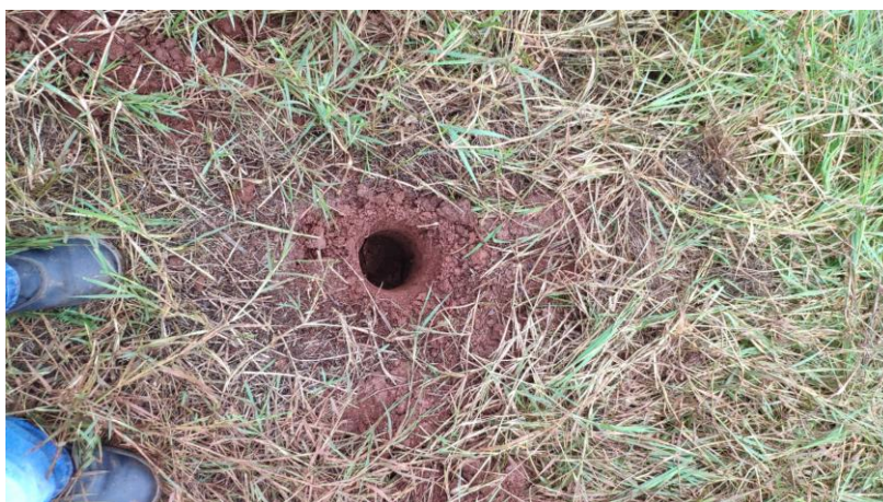
Figura 5 - Execução do ensaio de sondagem a trado, com utilização de trado concha.
