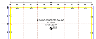
PLANTA BAIXA - VIGAS SUPERIORES
