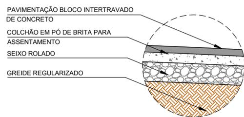
DETALHE PAVIMENTO SEM ESCALA
