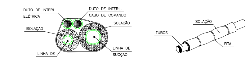
DET. ISOLAÇÃO TUBULAÇÃO FRIGORÍGENA S/ESC.
