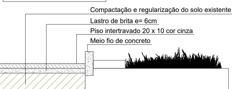
DETALHE PAVIMENTAÇÃO S/ESCALA
