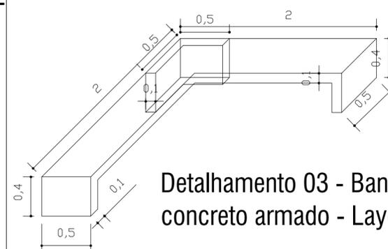
Detalhamento 03 - Banco de concreto armado - Layout 02
