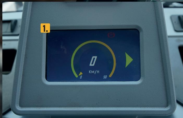
1. Display LCD com velocímetro e indicadores de acionamento das luzes dianteiras e de direção.
