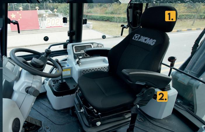
1. Banco do operador ergonômico com apoio de braço, suspensão mecânica regulável, com giro de 180°.
