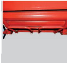
Rolos totalmente extrusados (sem emenda por solda) de alta durabilidade.
