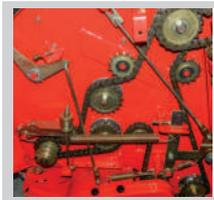
Parafuso de segurança acoplado diretamente ao sistema de transmissão / Engrenagens com tempera de alta dureza (ASA-60)
