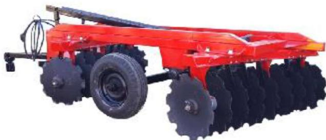
As Grades da Marca: **MetalFreitas** possuem todos os itens necessários para seu perfeito funcionamento, com Código FINAME e MDA. Inclusive pistão hidráulico para regulagem (controle remoto) e mangueiras para engate ao trator, possui trava no cilindro para transporte. Chassi com vigas tubulares e cantoneiras em Chapas de 6.35mm e 10.0mm (variação com modelo), discos com limpadores e mola estabilizadora.
